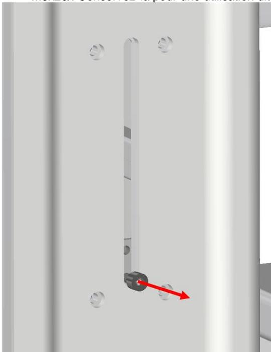
2. Fixer le support avec 4 vis M6x25 + rondelles + bagues (incluses) dans les 4 trous filetés du releveur de toilettes. Ne pas serrer trop fort les vis de manière à ce que le support puisse se déplacer librement de haut en bas dans les fentes. Elles seront ajustées plus tard.
