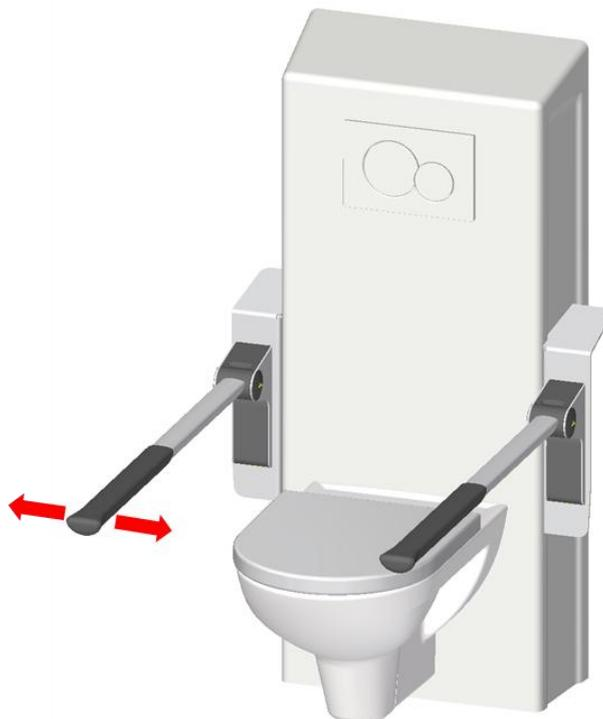
8. Montieren Sie den Abstandshalter zusammen mit der Abdeckplatte, wobei der Spanngriff in das untere Loch in der Mitte der Halterung eingreift, der Klemmgriff muss auch in die Plattenmutter auf der Rückseite eingreifen.
