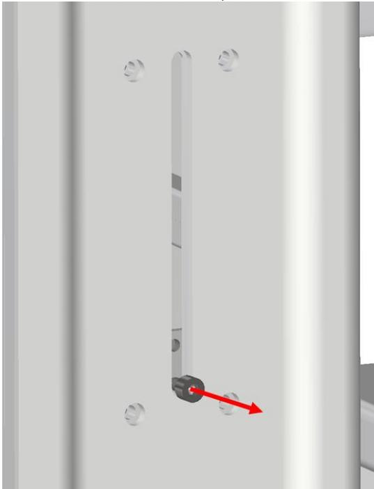
2. Montieren Sie die Halterung mit 4 M6x25-Schrauben + Unterlegscheiben und Buchsen (im Lieferumfang enthalten) in den 4 Gewindelöchern des Toilettenlifters. Die Schrauben leicht anziehen, damit sich die Halterung in den Schlitzen frei auf und ab bewegen kann. Später nachjustieren.
