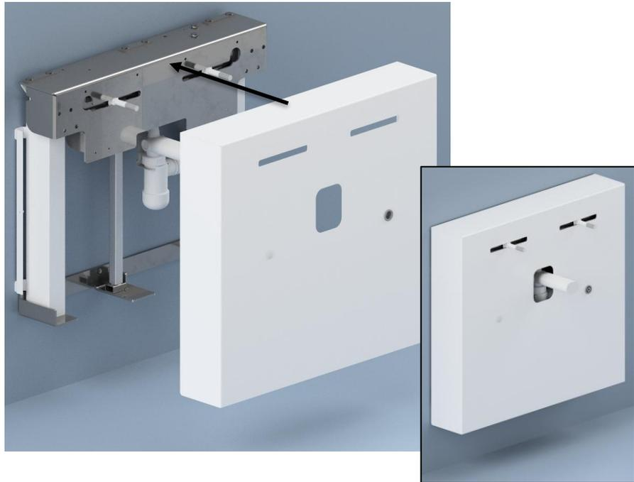
Pousser le couvercle extérieur en place sur l'unité. Les boulons doivent ressortir à travers le couvercle.
