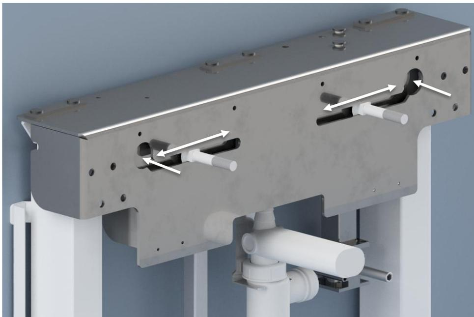
Monter les boulons du lavabo dans les fentes du support supérieur.
