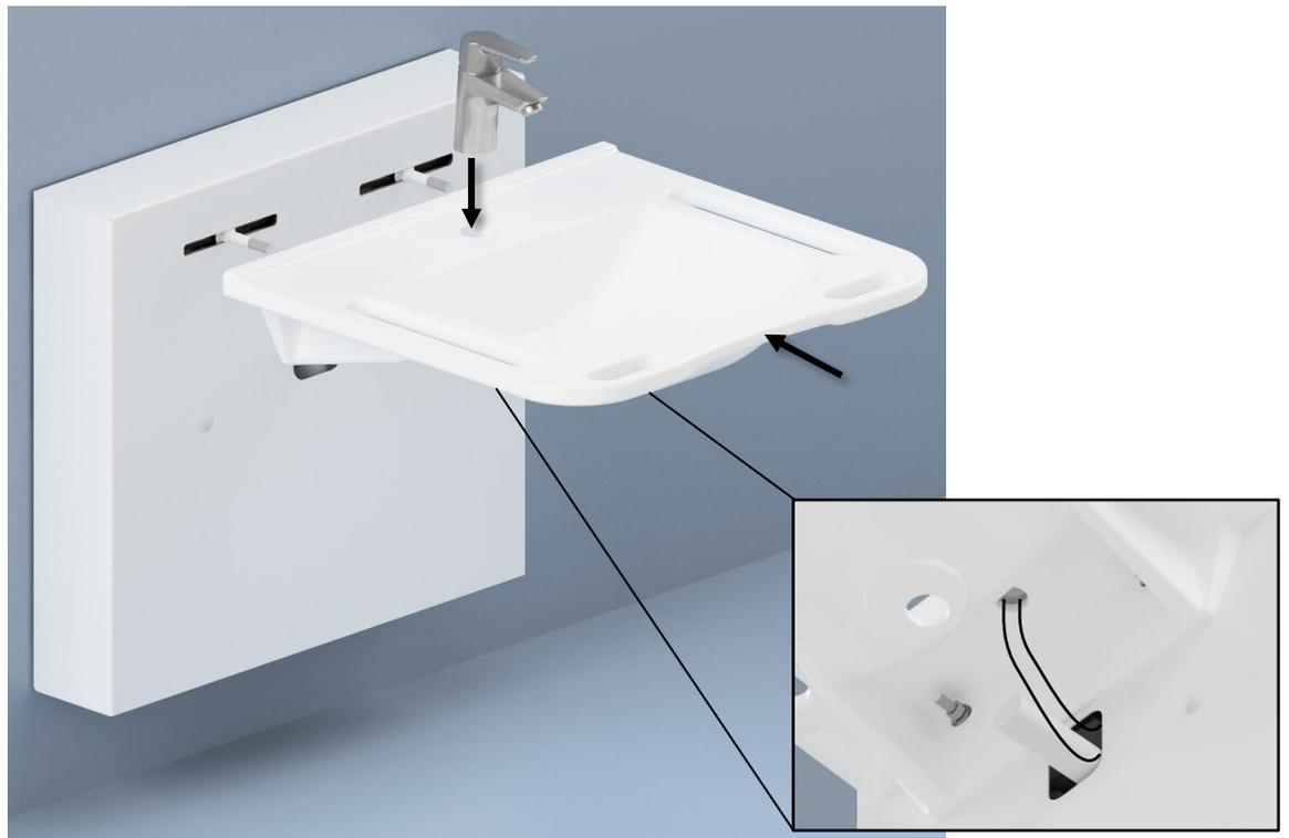
Fixer le lavabo à l'unité sur les boulons à l'aide des écrous et des rondelles fournis.
