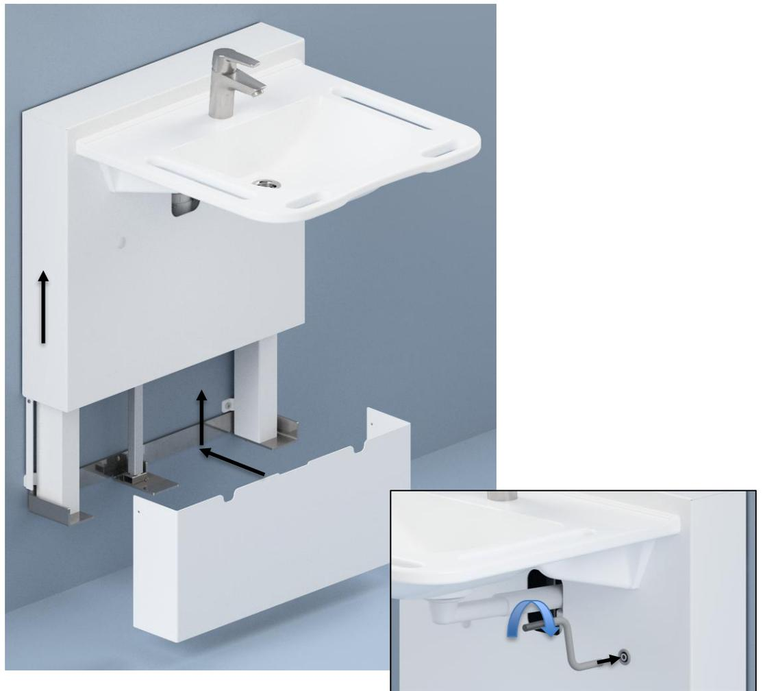
Relevez complètement l'unité en insérant la manivelle et en la tournant dans le sens horaire, puis raccordez le mitigeur à l'eau. Ouvrir l'eau. Remonter le couvercle intérieur sur l'unité.
