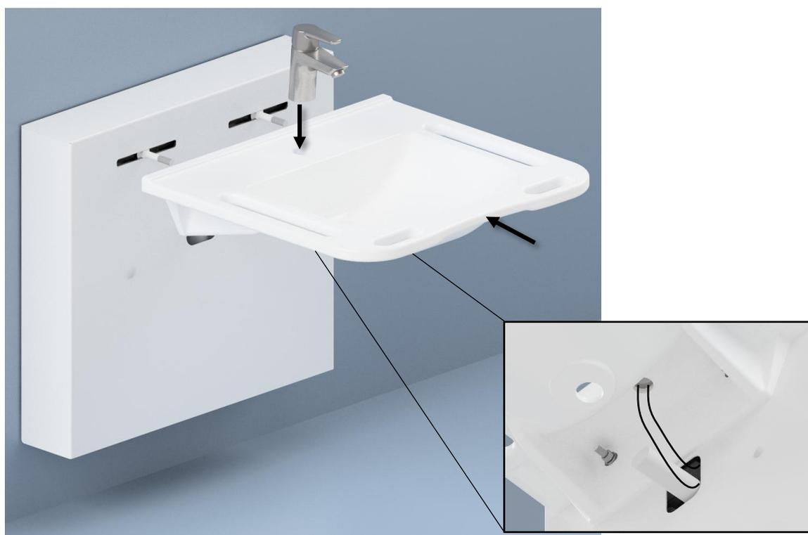
Bringen Sie das Waschbecken an der Einheit an den Schrauben an und befestigen Sie es mit den beiliegenden Muttern und Unterlegscheiben.
