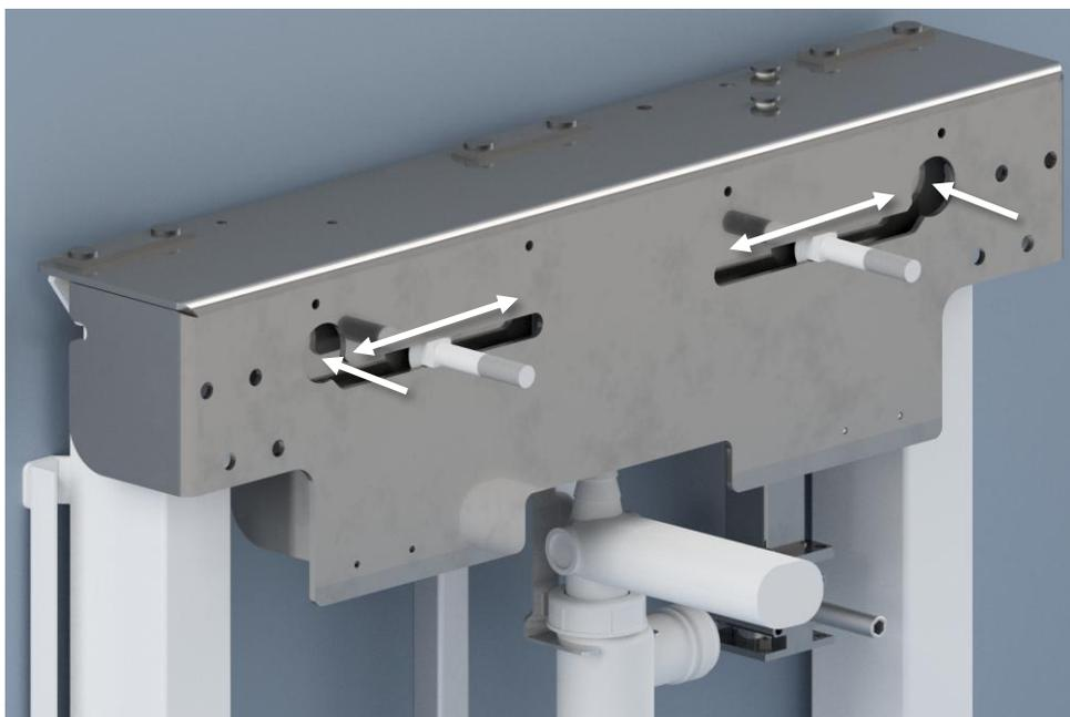
Befestigen Sie die Schrauben für das Waschbecken in den Schlitzern der oberen Halterung. Die Schrauben können seitlich verstellt werden, um die Montage verschiedener Becken zu ermöglichen.
