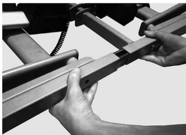
Hubmotor einhängen und den Bolzen einschieben.
