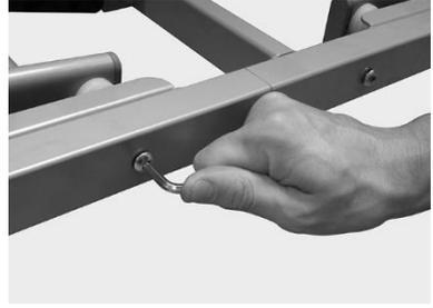
Die beiden Hälften der Liegefläche zusammenstecken und mit beiliegenden Schrauben festschrauben.
