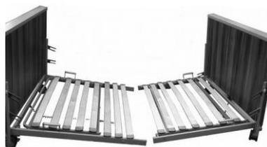
4. Per il montaggio delle protezioni laterali agganciare e centrare le protezioni laterali in legno nelle guide metalliche premontate. Quindi spingere completamente uno nell'altro gli elementi del piano di sdraio e avvitarli insieme. Montare quindi il motore del piano di sdraio secondo i simboli e collegare i singoli attuatori.
