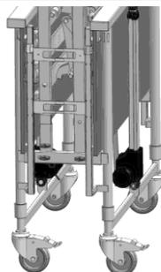
Anschließend kann der Aufrichter eingefügt werden. Dieser wird auf den vorhandenen freien Flachstahl gesteckt. Der Aufrichter sollte dabei nach innen zeigen.
