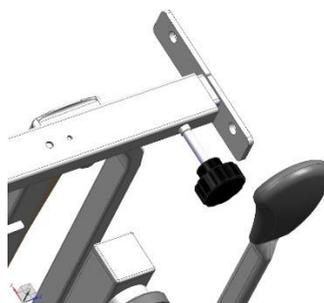
Fixez maintenant les attaches du matelas avec les vis à tôle fournies si cela n'a pas été effectué en usine (selon le mode d'expédition du lit médicalisé).
