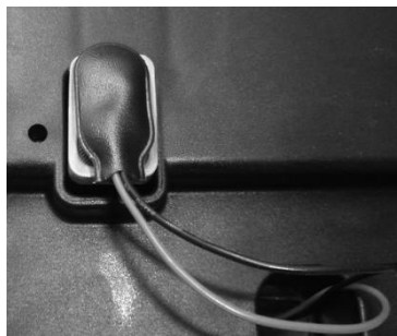
Pile 9 V pour l'abaissement d'urgence
