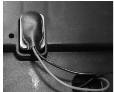
9-V-Blockbatterie für die Notabsenkung
