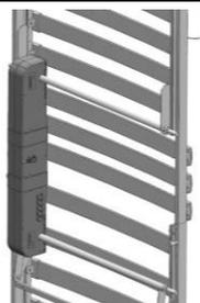
**Sur le domiflex® 3, le montage de l'entraînement double est ainsi terminé. Les entraînements individuels du domiflex® 3 plus sont montés de manière permanente et il suffit de les raccorder lors du montage. Pour les raccordements des systèmes moteurs, voir chapitre 2.5.4.1.1 / chapitre 2.5.4.1.2.**
