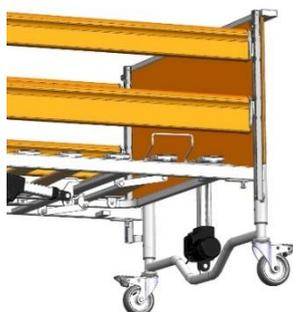
Tirer le panneau hors du plan de couchage jusqu'au premier enclenchement. Il s'agit de la position de montage et de démontage des barrières latérales.
