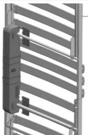
Glisser les plaques de couverture latéralement dans le dispositif de blocage de l'entraînement double.
