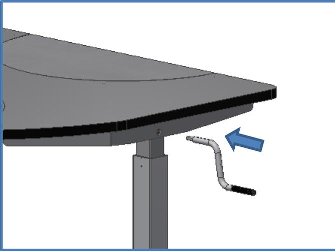
La hauteur est réglée manuellement en tournant la poignée située sur le côté de la table. En tournant la poignée dans le sens des aiguilles d'une montre, du côté droit de la table, la table se déplace vers le haut.
