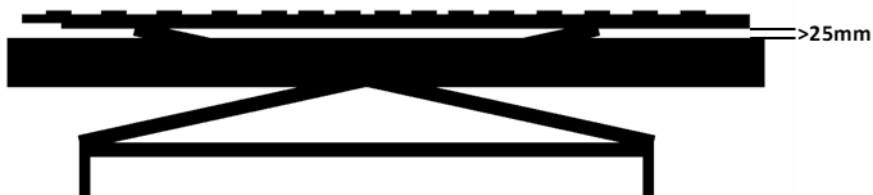
Figura 2: Se la distanza minima tra telaio del letto e bordo del letto non può essere rispettata, il piano di sdraio non deve essere immerso nel telaio del letto e può essere solo in modo tale che ci sia una distanza di almeno 25 mm (= 2,5 cm) tra il bordo superiore del bordo del letto e il bordo inferiore del telaio del letto.
