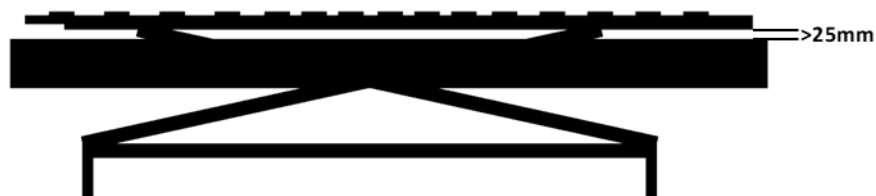
Figura 2: Se la distanza minima tra telaio del letto e bordo del letto non può essere rispettata, il superficie di sdraio non deve essere immerso nel telaio del letto e può essere solo in modo tale che ci sia una distanza di almeno 25 mm (= 2,5 cm) tra il bordo superiore del bordo del letto e il bordo inferiore del telaio del letto.
