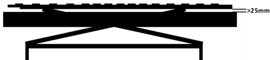
Abbildung 2: Wenn der Mindestabstand zwischen Bettgestell und Bettumrandung nicht eingehalten werden kann, darf die Liegefläche nicht in die Bettumrandung eintauchen und nur soweit heruntergefahren werden, dass zwischen der Oberkante der Bettumrandung und der Unterkante des Bettgestells ein Abstand von mindestens 25mm (= 2,5 cm) vorliegt.
