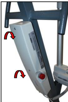
7-8/ Kontrollbox mit den 2 Fixierschrauben (CHC 6X80) am Mast fixieren.
