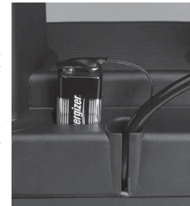
Pile monobloc de 9 volts pour l'abaissement d'urgence
