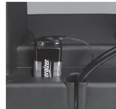
Pile monobloc de 9 volts pour l'abaissement d'urgence
