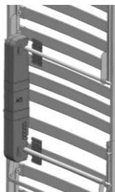
Far scorrere lateralmente le piastre di copertura nel meccanismo di bloccaggio del doppio attuatore.
